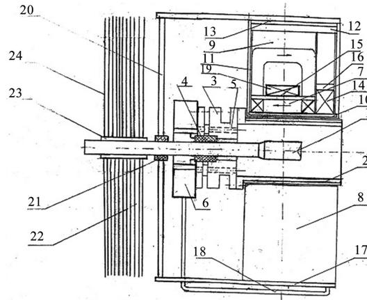
**Figure 14.** Superconducting electric rocket engine “MARS”\* (longitudinal section). \*Abbreviation of the engine name in German language: Motor für die Alrakete mit der Supraleitung.
